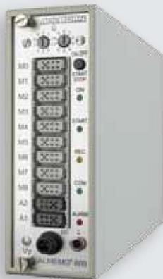
**Přesný měřicí přístroj ALMEMO® nejnovější generace V7. 9 měřicích vstupů pro všechny snímače. Provoz jako datalogger nebo jako PC rozhraní. Zvýšená přesnost a vysoká rychlost měření, se snímačem ALMEMO® D7 až 1000 měření/s.**
